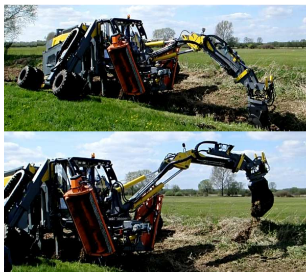
Fig. 10. Removal of silt using the bucket of multi-task machine Rys. 10. Usuwanie namulów byżką podsiębierną
