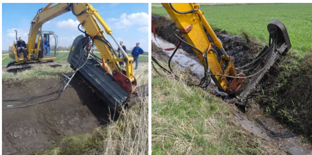
Fig. 2. Tests of the soil regenerator on the excavator arm Rys. 2. Testy freza ślimakowego na wysięgniku koparki
