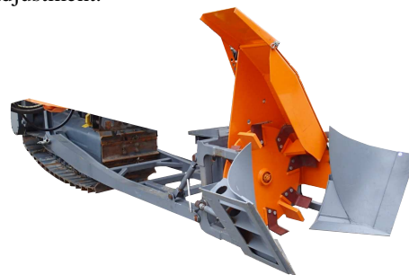
Fig. 5. Scraping ploughshare with a rotary ditcher Rys. 5. Lemiesz zgarniający z odmularką rotacyjną
