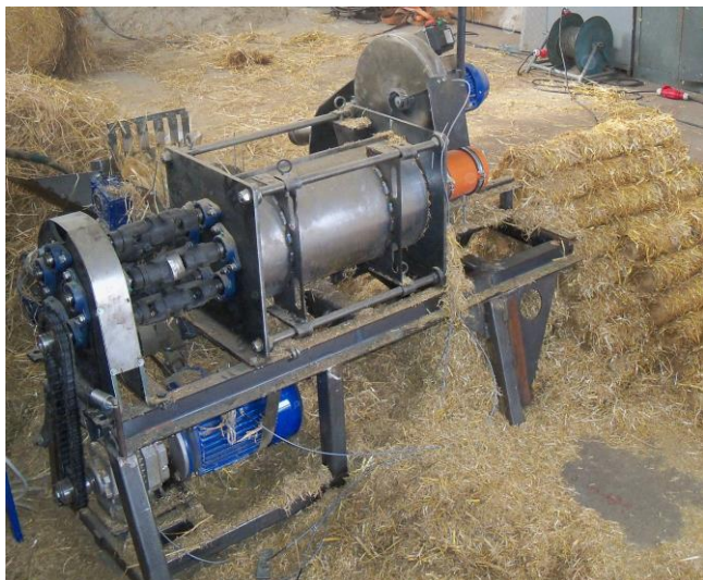
Fig. 3. The stationary briquetting machine during the study Rys. 3. Stacjonarna maszyna brykietująca podczas badań
