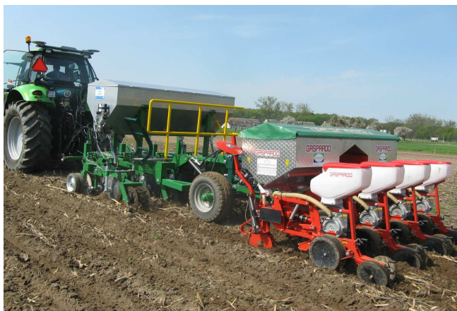
Fig. 3. Unit during strip tillage, fertilizing and corn seeding Rys. 3. Model badawczy agregatu podczas uprawy pasowej, nawożenia i siewu kukurydzy
