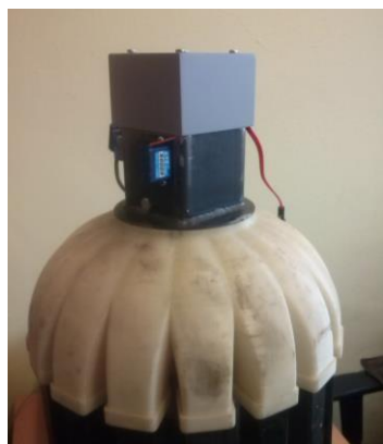
Fig. 4. Seed distribution uniformity collector prototype mounted on the drill head Rys. 4. Prototyp ulepszanego kolektora równomierności rozdziału nasion zamontowany na głowicy rozdzielczej
