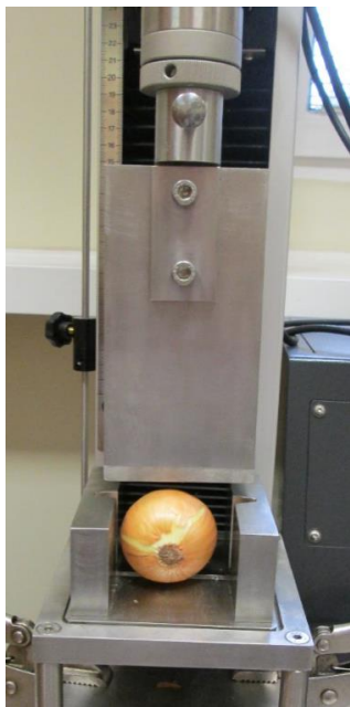
Fig. 3. Placement of onion before cutting Rys. 3. Ustawienie cebuli przed przecięciem
