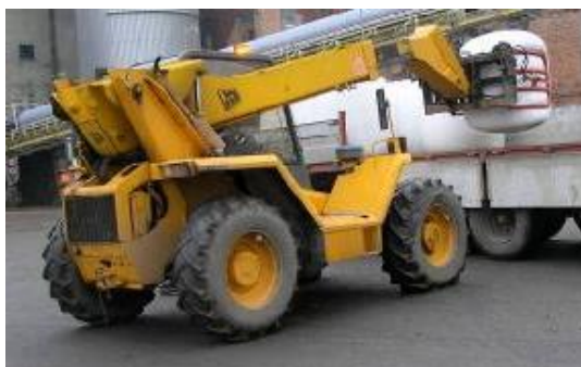
Fig. 1. Loading sugar beet pulp: a - directly from the feeder of the sugar factory line to the hopper of the preheater; b - using telescopic loader with gripper to cylindrical bales Rys. 1. Załadunek wysłodków buraczanych: a – bezpośrednio z podajnika linii technologicznej cukrowni do kosza zasypowego prasowijarki; b – za pomocą ładowarki teleskopowej z chwytakiem do cylindrycznych bel
