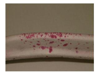
Fig. 10. Another part of the deformed arm suspension with a cluster of discontinuities [7] *Rys. 10. Inna część odkształconego ramienia zawieszenia z klastrem nieciągłości [7]*
