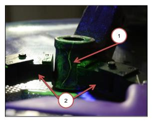
Fig. 12. UV magnetic particle method for car suspension part (balance lever): 1 – crack, 2 – arms of the magnetic device [7] *Rys. 12. Metoda magnetyczno-proszkowa UV w badaniu części zawieszenia (ucha dźwigni): 1 – pęknięcie, 2 – końcówki defektoskopu magnetycznego [7]*
