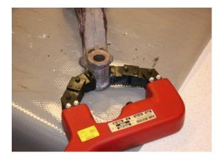
Fig. 11. View of the lever eye of truck suspension tested by the magnetic device using special arms [7] *Rys. 11. Widok ucha dźwigni zawieszenia ciężarówki testowanego defektoskopem magnetycznym ze specjalnymi koń-*
