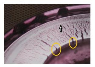
Fig. 13. The area of cracks and microcracks detected in surface of flywheel by common coloured penetrant method [7] *Rys. 13. Obszar pęknięć i mikropęknięć wykrytych w powierzchni koła zamachowego przez zwykłą koloryzująca meto-*
