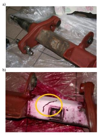
Fig. 6. View of BPW axle of semi-trailer with suspicion of cracks (a) and detected crack by penetrant method (b) [7] *Rys. 6. Widok osi naczepy BPW z podejrzeniem pęknięć (a) i wykryte pękniecie metodą penetracyjną (b)* [7]
