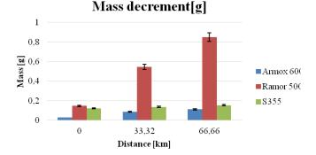
Fig. 4. Mass decrement of the sample depending on the distance traveled in the soil during the experiment [7] *Rys. 4. Zmniejszenie masy próbki w zależności od odległości pokonanej w glebie podczas eksperymentu* [7]
