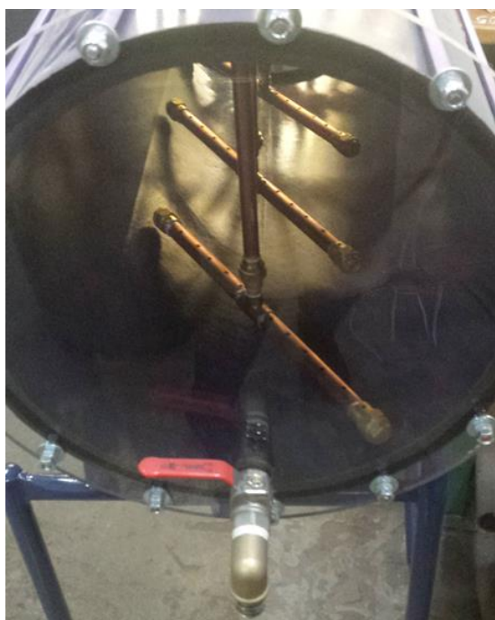
Fig. 5. Placement of the pulverizers in the inactivation chamber Rys. 5. Rozmieszczenie pulweryzatorów w komorze inaktywacyjnej
