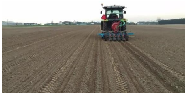
Fig. 1. Onion sowing with automatic parallel control system Rys. 1. Siew cebuli z automatycznym systemem prowadzenia równoległego
