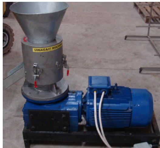
Fig. 1. ZPL rotary pellet machine Rys. 1. Peleciarka talerzowa ZPL
