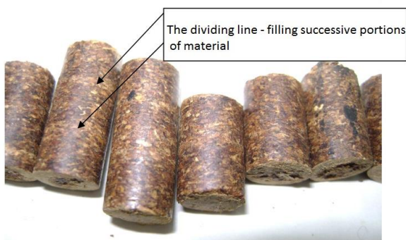
Fig. 6. View of the granulate (obtained with the parameters: l_m = 42 mm and m_p = 0,6 g) with visible dividing lines resulting from backfilling of subsequent raw material samples Rys. 6. Widok granulatu (otrzymanego przy parametrach: l_m = 42 mm oraz m_p = 0,6 g) z widocznymi liniami podziału wynikającymi z zasypywania kolejnych próbek surowca
