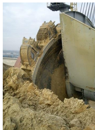
Fig. 4. Full and chain buckets fitted interchangeably on the bucket wheel of a SchRs-900 excavator [1] Rys. 4. Czerpaki pełne oraz łańcuchowe zamontowane na koparce wielonaczyniowej SchRs-900 [1]
