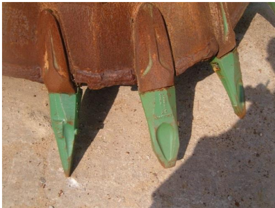
Fig. 7. New teeth fitted on the excavator bucket [1] Rys. 7. Nowe zęby zamontowane na łyżce koparki [1]
