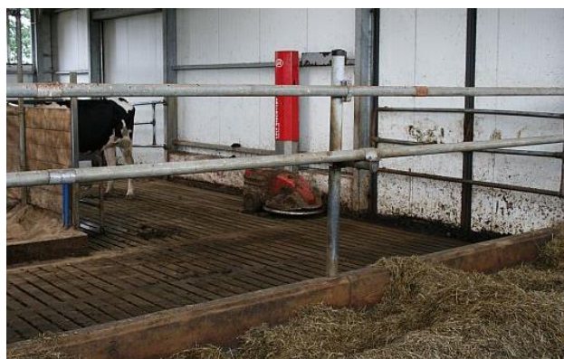
Fig. 3. A robot manufactured by Lely cleaning cavity floor Rys. 3. Robot firmy Lely czyszczący podłogę szczelinową
