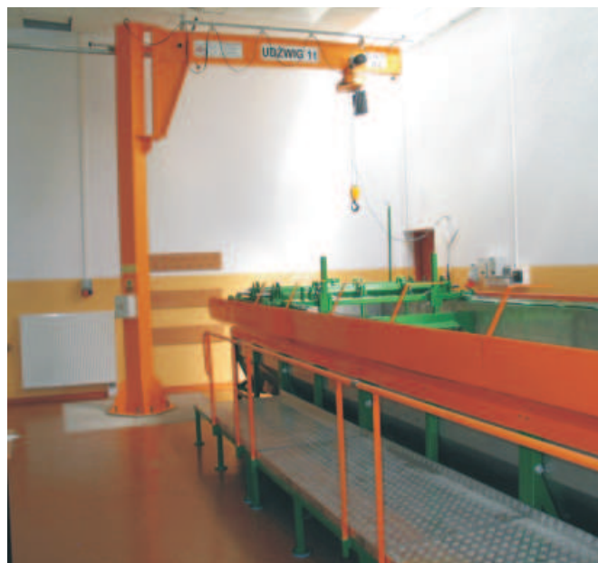
Rys. 1. Laboratorium badań narzędzi uprawowych w kanale glebowym
