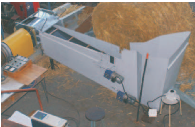
Rys. 1. Stanowisko laboratoryjne do brykietowania niepociętych materiałów lodygowych metodą zwijania Fig. 1. Laboratory stand to briquetting of the stalk material not cut on the chaff by the method of the curling
