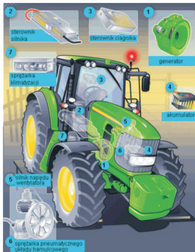
Rys. 4. Ciągnik rolniczy John Deere 7430E z generatorem elektrycznym [3]
