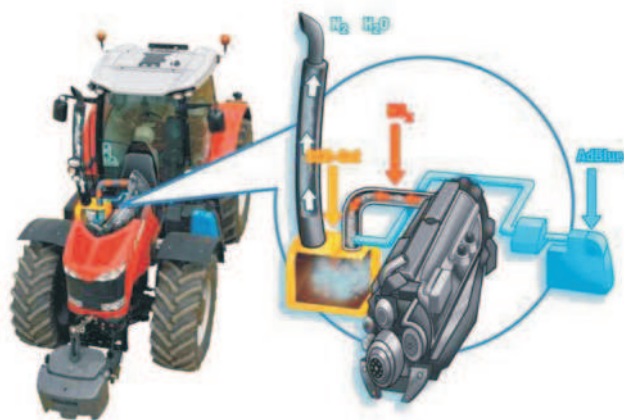
Rys. 2. Układ SCR silnika ciągnika rolniczego Massey Ferguson [3]
