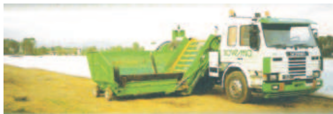
Rys. 4. Prasa silosująca napędzana ciągnikiem siodłowym Fig. 4. Silage compactor powered by the truck-tractor
