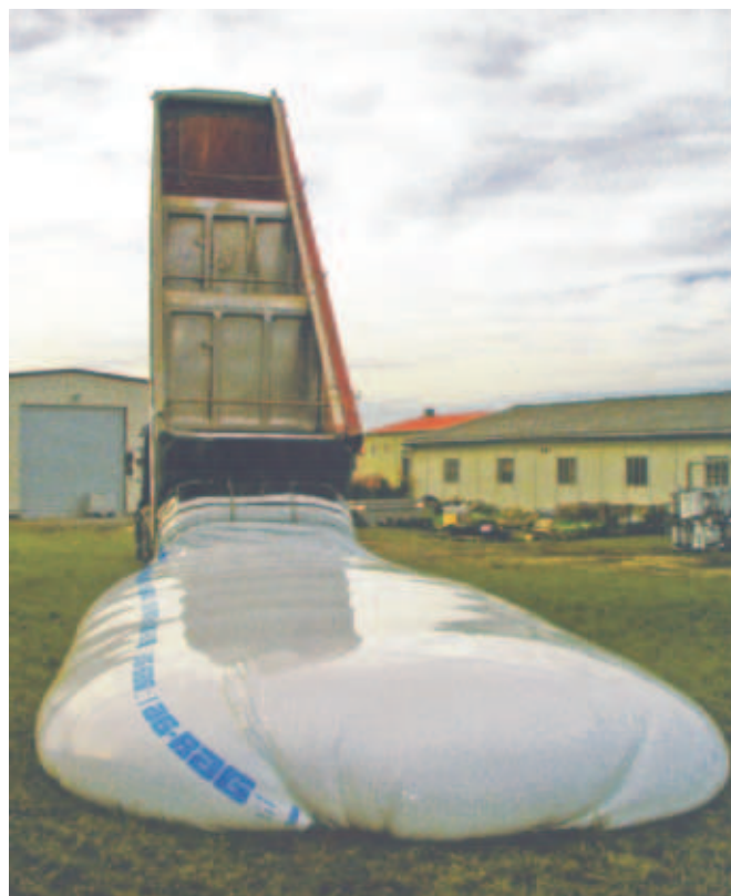
Rys. 8. Maszyna TRUCKBAGGING podczas napełnianie rękawa foliowego młótem browarnianym Fig. 8. TRUCKBAGGING machine during filling of plastic bag with brewer's draff
