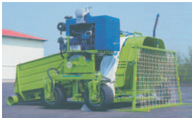
Rys. 2. Prasa silosująca M 7000 EUROPE wyposażona we własną jednostkę napędową Fig. 2. M 7000 EUROPE Silage Compactor equipped with its own power unit
