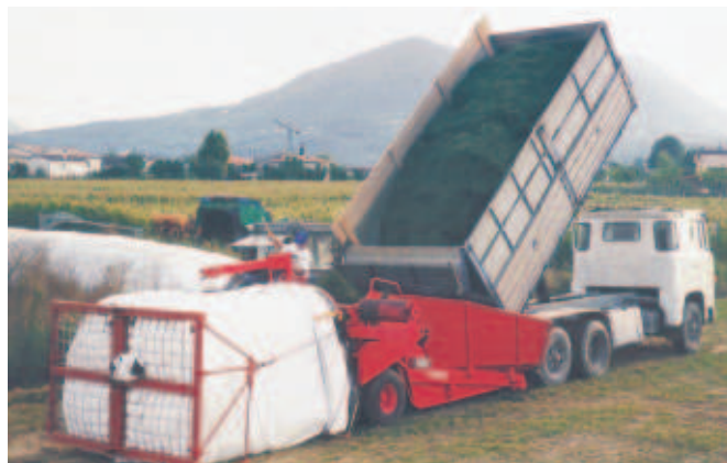
Rys. 1. Prasa silosująca firmy Maragon podczas napełniania worka foliowego rozdrobnioną zielonką
