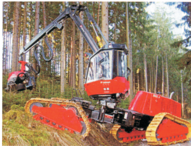
Rys. 4. Harwester wysięgnikowy wsparty na czterech gąsienicach Fig. 4. Boom harvester supported by four caterpillars
