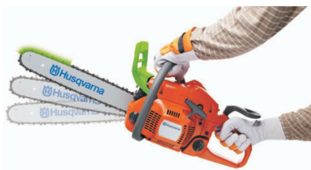
Rys. 2. Widok przedniej dźwigni hamulca pilarki w trakcie odbicia Fig. 2. View of the front brake lever in the power chain saw during reflection
