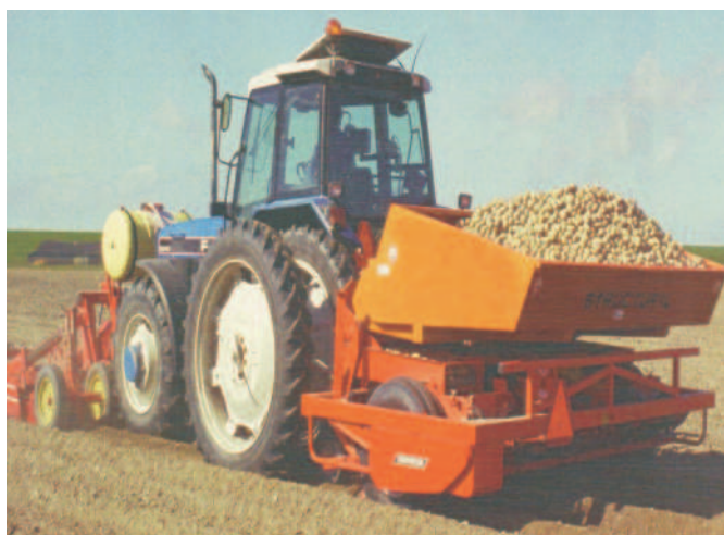
Rys. 4. Sadzarka taśmowo palcowa Structural z zaprawiarką sadzeniaków pozwala uzyskać wysokie plony na dużych plantacjach w rozstawie międzyrzędzi 75-90 cm
