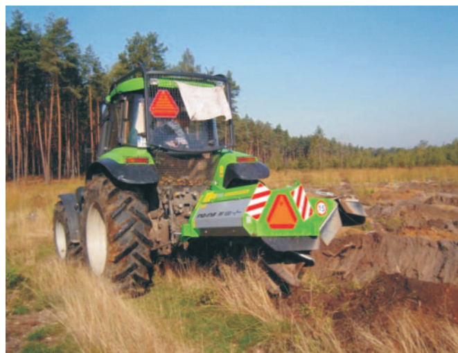
Rys. 10. Pługofrezarka PF 100 firmy Fao Far podczas wykonywania rabatowalków
