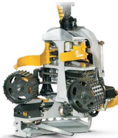
Rys. 3. Głowica harwesterowa Kesla 18 RH Fig. 3. Harvester head Kesla 18 RH
