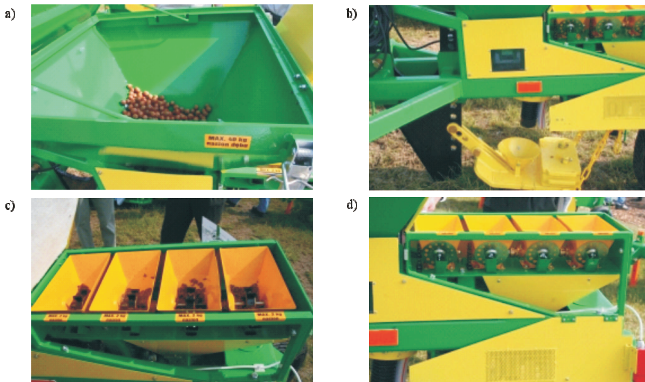
Rys. 5. Główne elementy siewnika SZU Sobańskiego: a - zbiornik siewnika dużego, b - redlica do wysiewu nasion grubych, c - zbiorniki siewnika małego, d - tarcze aparatów wysiewających siewnika małego Fig. 5. Main elements of the SZU Sobański's seeder: a - reservoir of the large seeder, b - drill coulter for sowing the large seeds, c - reservoirs of the small seeder, d - discs of sowing mechanism in small seeder
