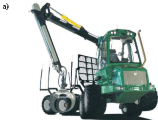
Rys. 7. Forwarder Greemo 1050 F z uniesionymi przednimi wózkami bogie (a), siłownik hydrauliczny unoszenia prawego przedniego koła wózka tandemowego (b) Fig. 7. Forwarder Greemo 1050 F with raised front carts bogie (a), the hydraulic servo-motor for lifting out the right front wheel of tandem cart (b)
