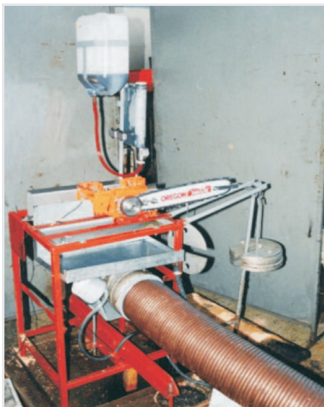
Stanowisko SBS-2 do porównawczych badań smarności oleju układu tnącego pilarki łańcuchowej
