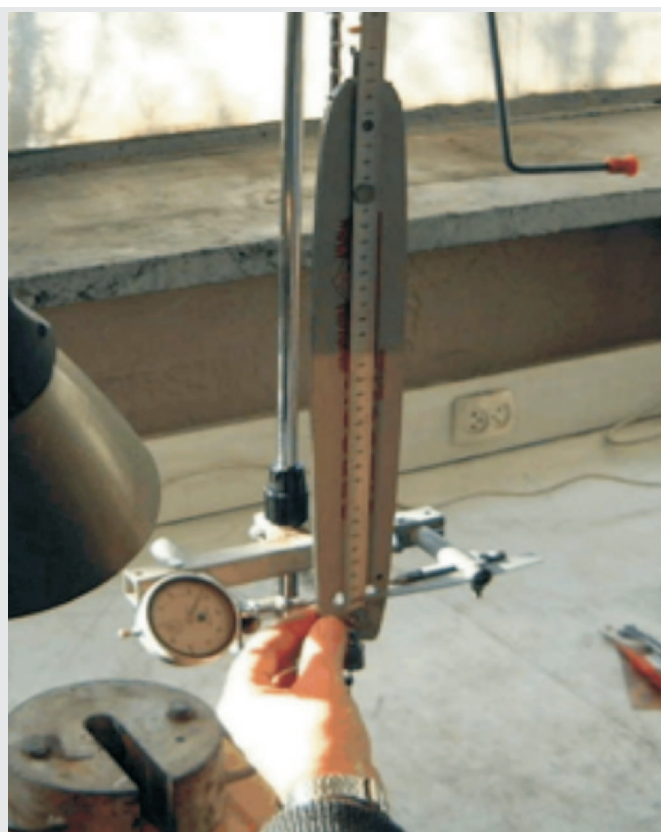
Stanowisko SPP-1 do pomiaru zużycia prowadnicy
