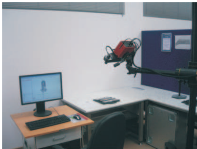
Rys. 1. Widok skanera optycznego ATOS II firmy GOM, znajdującego się w Laboratorium Rapid Prototyping w Przemysłowym Instytucie Maszyn Rolniczych w Poznaniu
