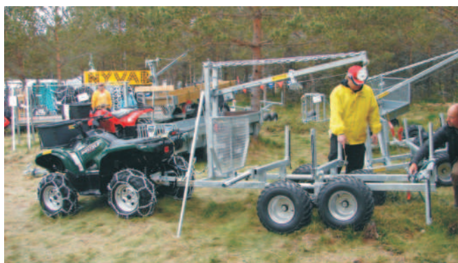
Rys. 4. Quad z przyczepką wyposażoną w mini żuraw jako zestaw zrywkowy
