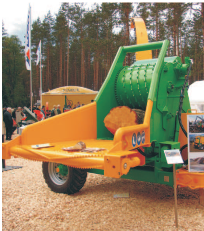
Rys. 9. Maszyna do rozdrabniania dłużycy na zrębki energetyczne Fig. 9. Machine for producing biofuel chips of wood logs
