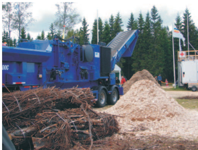
Rys. 8. Maszyna do pozyskiwania biopaliwa z pozostałości pozrębowych Fig. 8. Machine for producing biofuel of felling wastes
