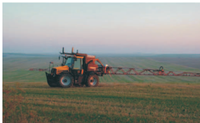
Rys. 2. Ciągnik JCB Fastrac 2140 Quadtronic z belką połową o szerokości roboczej 28 m w trakcie bicia rekordu
