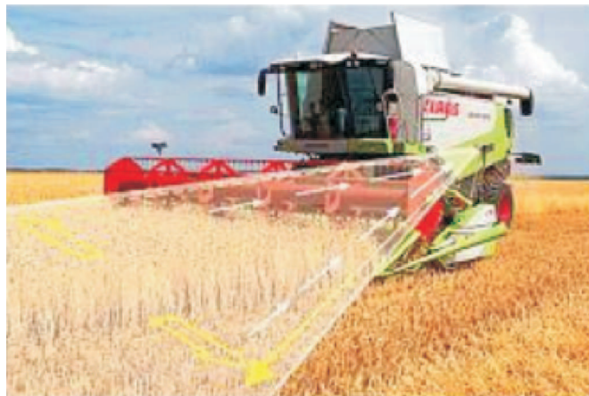
Rys. 1. Kombajn z laserowym systemem sterowania i korekty toru ruchu [12]
