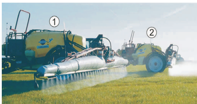
Rys. 6. Opryskiwacz z rękawem powietrznym: 1 - opryskiwacz z włączonym rękawem, 2 - opryskiwacz z wyłączonym rękawem
