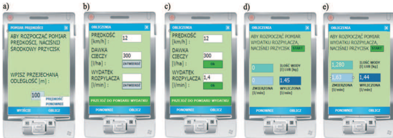
Rys. 1. a - Pomiar czasu przejazdu i prędkości praktycznej opryskiwacza polowego za pomocą aplikacji mobilnej (uruchomionej na emulatorze urządzenia), b - Obliczanie wydatku jednostkowego, c - Wynik działania drugiej funkcji aplikacji, d - Pomiar rzeczywistego wydatku rozpylacza, e - Analiza wartości wyliczonej i zmierzonej wydatku
