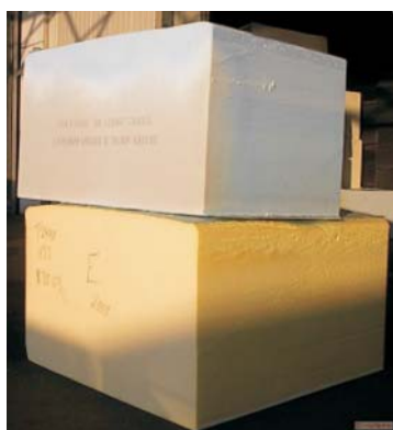
Rys. 2. Gotowy produkt pianki poliuretanowej w postaci dużego bloku [1] Fig. 2. Finished products of polyurethane foams in the form of the great block [1]
