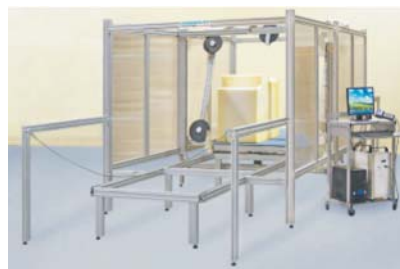
Rys. 3. Maszyna do cięcia pianki poliuretanowej [1] Fig. 3. Cutting machine for polyurethane foams [1]
