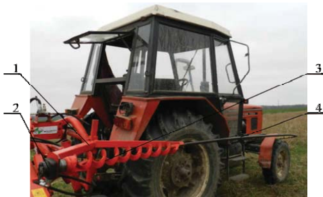
Rys. 3. Zespół układający ścięte łodygi roślin energetycznych: 1 - rama zespołu układającego, 2 - silnik hydrauliczny, 3 - podajnik ślimakowy, 4 - prowadnica ściętych pędów
