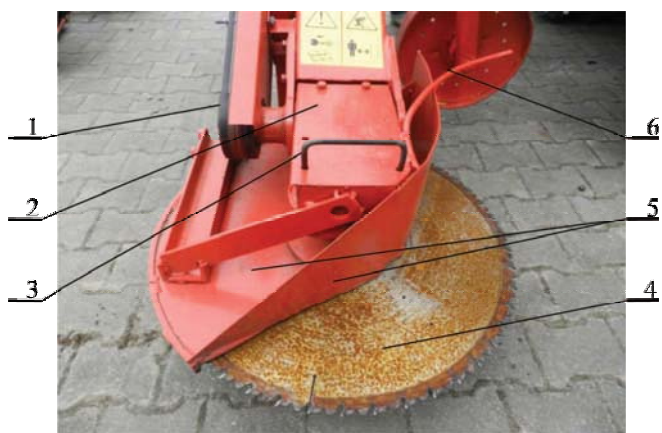
Rys. 2. Zespół tnący ścinarki: 1 - przekładnia pasowa napędu piły, 2 - ramię zawieszenia piły, 3 - uchwyt do zmiany położenia ramienia zawieszenia piły z transportowego na robocze i odwrotnie, 4 - piła tarczowa, 5 - osłona piły z pionowym elementem prowadzącym, 6 - pręt naprowadzający ścięte pędy na podajnik ślimakowy
