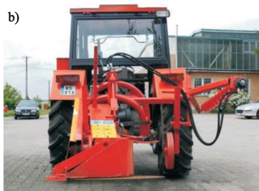
Rys. 5. Ścinarka JSR 750: a - w położeniu roboczym, b - w położeniu transportowym
