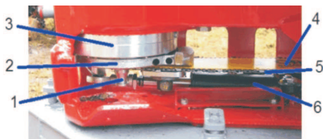
Rys. 5. Zespół tnący głowicy harwesterowej: 1 - wychwytnik piły łańcuchowej, 2 - obsada prowadnicy wraz z układem napinania piły łańcuchowej, 3 - silnik hydrauliczny napędu piły łańcuchowej, 4 - prowadnica, 5 - piła łańcuchowa, 6 - siłownik hydrauliczny posuwu piły łańcuchowej
