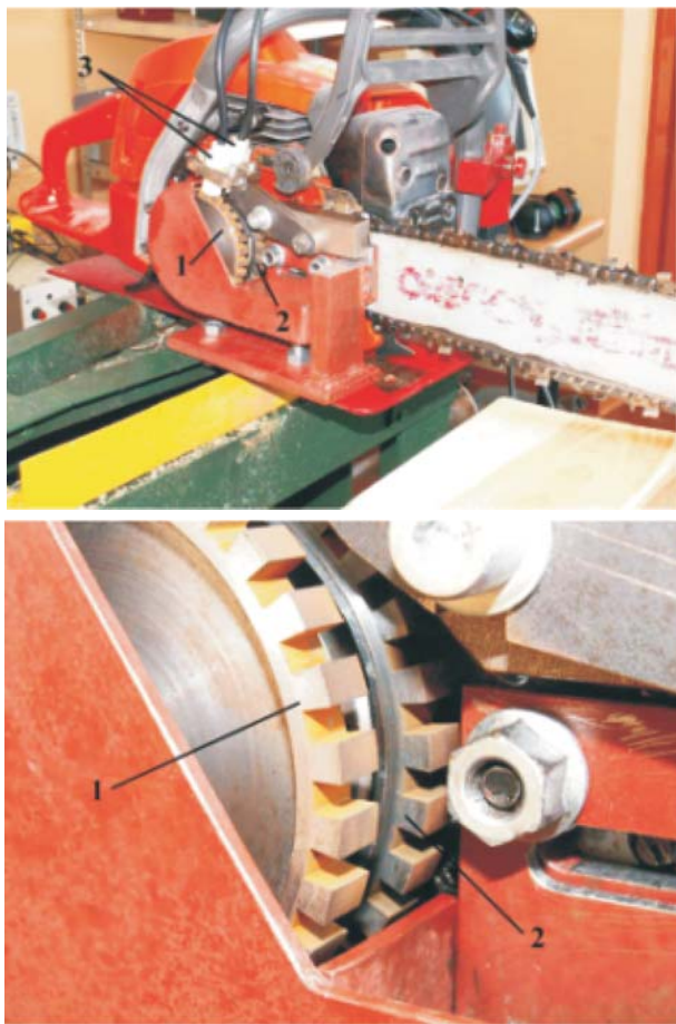
Rys. 3. Pilarka z układem do pomiaru chwilowych prędkości obrotowych: 1 - koło zębate na wale korbowym, 2 - koło zębate na bębnie sprzęgła, 3 - czujniki
