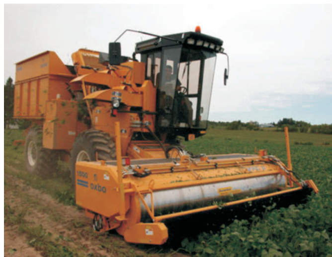
Rys. 3. Kombajn Oxbo 2470 z zespołem VPC1500 do zbioru strąków fasoli szparagowej [7]
