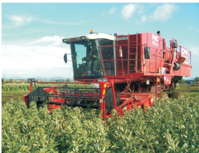
Rys. 6. Samojezdny kombajn PMC 979-CT podczas pracy z zespołem do zbioru bobu [8] Fig. 6. PMC 979-CT self-propelled harvester with a broad bean picking unit at work [8]
