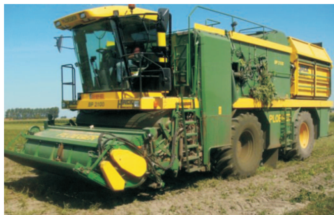
Rys. 1. Widok samojezdnego kombajnu Ploeger BP2100 od strony zespołu zrywającego [9]
