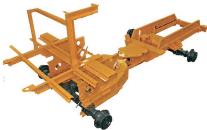
Rys. 2. Rama główna samojezdnego kombajnu firmy Oxbo ma budowę przegubową [7]
