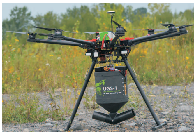
Rys. 3. Rozsiewacz granulatu USG-1 zamontowany na dronie DJI-S1000+
