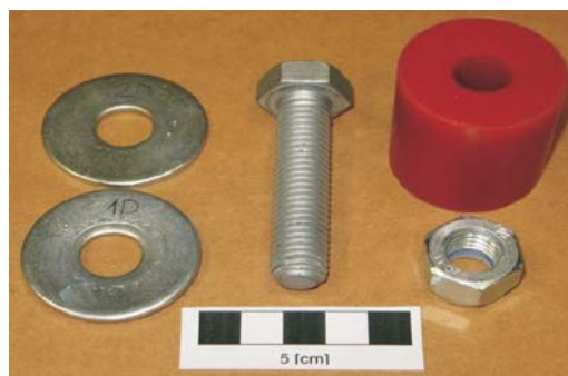
Rys. 1. Budowa zespołu elementu dystansowego Fig. 1. Construction of the elastomeric spacer
