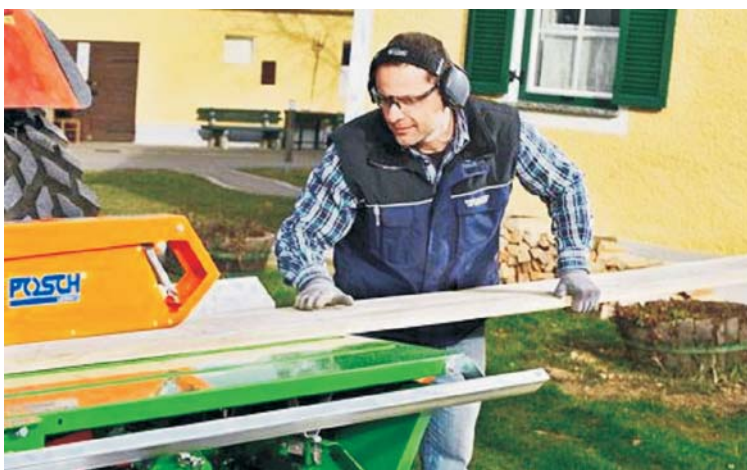
Rys. 3. Pilarka tarczowa z kołyską TWE / TWKE (cięcia poprzeczne i wzdłużne) Fig. 3. Circular saw with cradle TWE / TWKE (to transverse and longitudinal cutting)
