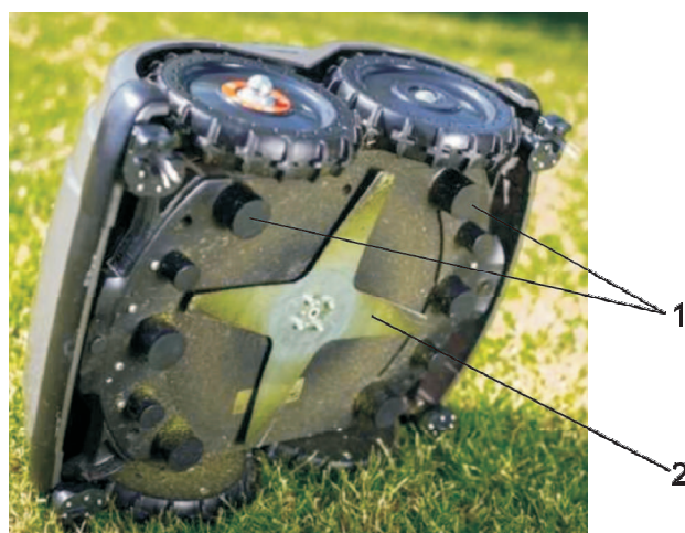
Rys. 2. Zespół tnący kosiarki automatycznej firmy Stiga: 1 - czujniki, 2 - nóż tarczowy [6]
