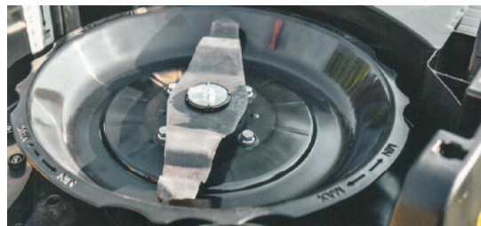
Rys. 6. Zespół tnący kosiarki automatycznej firmy John Deere [6] Fig. 6. Cutting assembly of the automatic mowing machine manufactured by John Deere [6]
