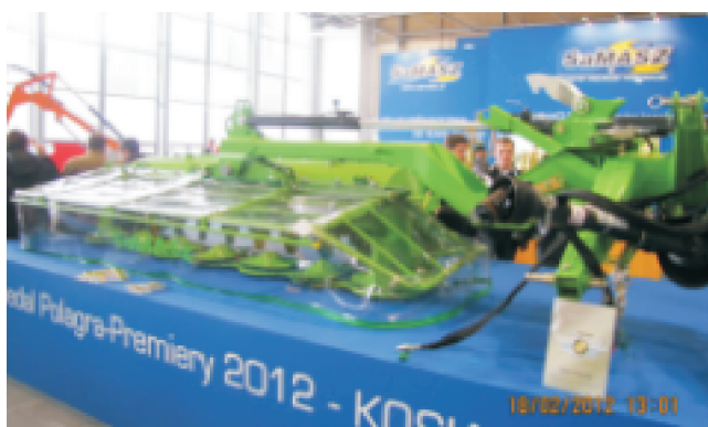
12. Kosiarka dyskowa tylna KT 301 SH z centralnym zawieszaniem i spalnicznikiem, produkcji SaMASZ Sp. z o. o., Białystok
