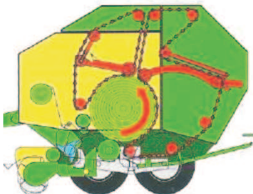
Rys. 1. Prasa zwijająca zmiennokomorowa przenośnikowa: a - widok maszyny, b - schemat działania Fig. 1. Variable chamber round baler conveyor with chain & slat conveyor: a - view of the machine, b - scheme of operation
