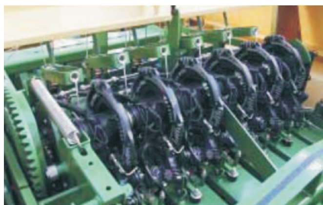
Rys. 4. Zespół wiążący w prasie tłokowej wielkogabarytowej
