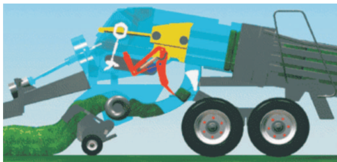
Rys. 3. Schemat tłokowej prasy wielkogabarytowej z widłowym zespołem zasilającym
