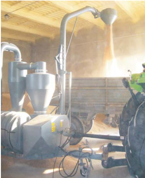
Rys. 2. Badany przenośnik pneumatyczny w trakcie pracy Fig. 2. Tested pneumatic conveyor during operation
