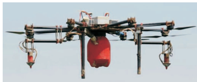
Rys. 3. Dron z rozpylaczami obrotowymi [11] Fig. 3. Drone with rotary atomizers [11]
