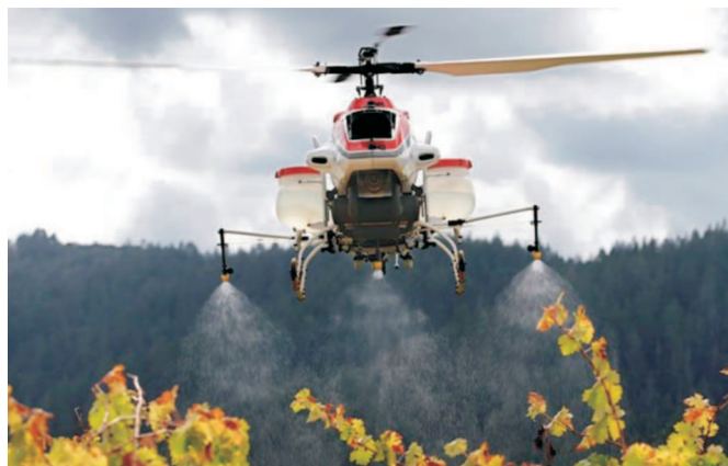
Rys. 1. Yamaha RMAX podczas wykonywania oprysku [12] Fig. 1. Yamaha RMAX in the course of spraying [12]
