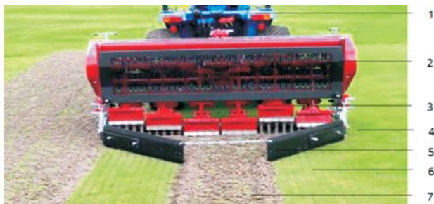
Rys. 9. Aerator Redexim Verti-Core II 1600: 1- ciągnik, 2- aerator zawieszany, 3- wahacze z nożami roboczymi, 4- wygląd trawnika przed aeracją, 5- zgarniacz „korków” glebowych, 6- wygląd trawnika po aeracji, 7- „korki” glebowe [13]
