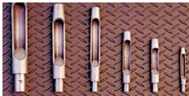
Rys. 2. Przykład konstrukcji noży rurkowych o różnych średnicach do aeracji wgłębnej [13]
