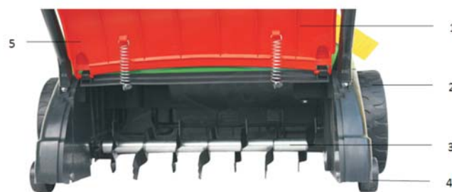
Rys. 4. Wertykulator elektryczny AL-KO Brill 38 z zamontowanym wałkiem nożowym: 1- uchwyt ręczny, 2- koło jezdne, 3- wałek wertykulatora, 4- koło podporowe, 5- pokrywa kosza [14]
