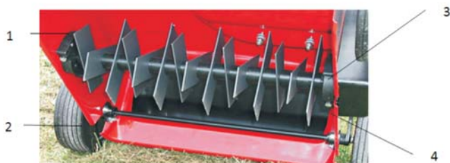
Rys. 6. Wertykulator SOLO 518 z nożami płaskownikowymi: 1- metalowa obudowa, 2- koło jezdne, 3- wał roboczy wertykulatora, 4- nóż płaskownikowy wertykulatora [16]
