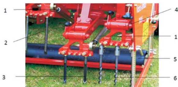
Rys. 10. Widok zespołu roboczego ciągnikowego aeratora Verti Drain: 1- siłownik hydrauliczny, 2- nóż prętowy, 3- nóż rurkowy, 4- wahacz roboczy, 5- wał, 6- nóż śrubowy [19]
