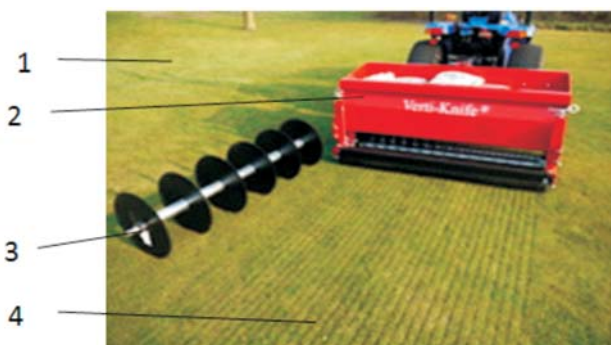
Rys. 7. Tarczowe i łukowe noże wertykulatorów: 1- wygląd trawnika przed wertykulacją, 2- tarczowy wertykulator ciągnikowy, 3- wał roboczy wertykulatora tarczowego, 4- wygląd trawnika po wertykulacji tarczami, 5- wał wertykulatora z łukowymi nożami, 6- nóż łukowy [17]
