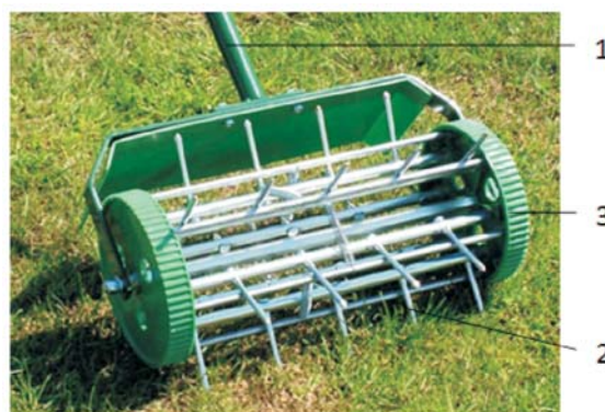
Rys. 1. Ręczne aeratory nożowe i kolcowe: 1- uchwyt ręczny, 2- krój nożowy i kolec, 3- kółka aeratora [11, 12]
