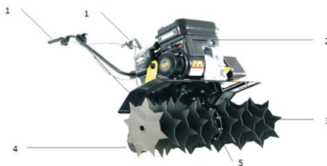
Rys. 5. Wertykulator z gwiazdowym zespołem roboczym, napędzany silnikiem spalinowym: 1- dźwignie sterowania aeratorem, 2- silnik spalinowy, 3- gwiazdowy zespół roboczy, 4- koło jezdne, 5- przekładnia napędowa [15]
