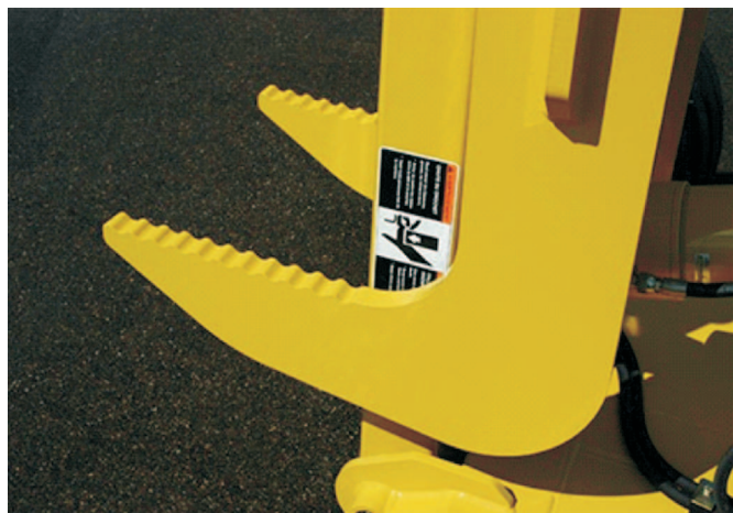
Rys. 3. Karbowane zęby chwytające [9] Fig. 3. Serrated grabbing teeth [9]
