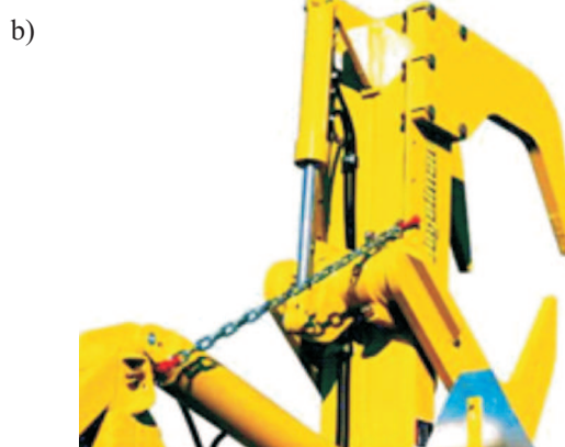
Rys. 5. Wyciągacz kamieni RD 320 firmy Degelman: a) transport po drodze, b) łańcuch zabezpieczający z karabińczykami [9] Fig. 5. Degelman's rock digger RD 320: a) transport on the road, b) safety chain with snap hook [9]
