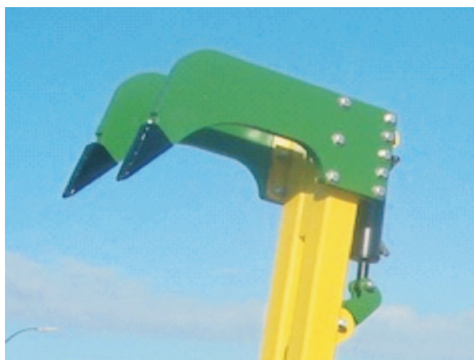
Rys. 4. Zęby z wymiennymi, ścierającymi się końcówkami [8] Fig. 4. Teeth with replaceable wear tips [8]
