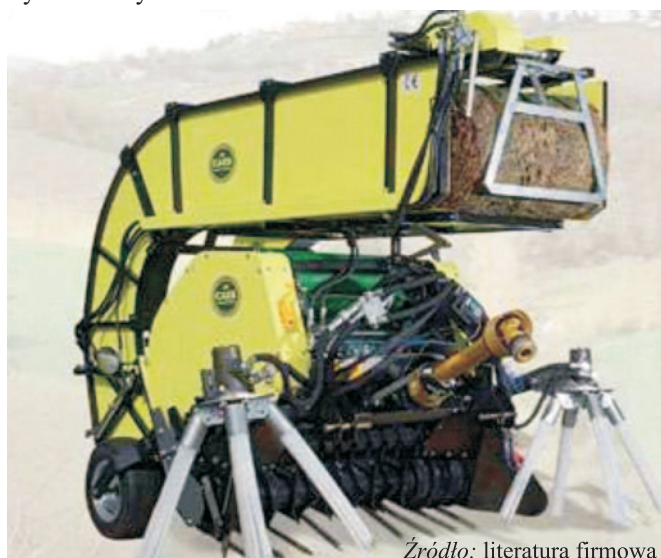
Rys. 2. Prasa belująca do zbioru gałęzi Quickpower 1230 z transporterem bel i szczotkami nagarniającymi Fig. 2. Quickpower 1230 Round Baler for cut vine branches with bale transporter and gathering brushes
