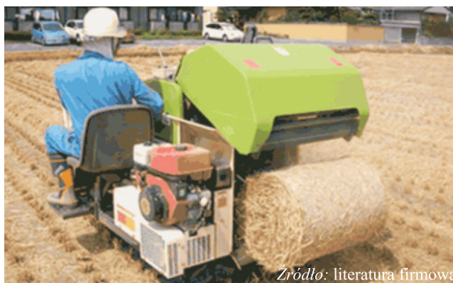
Rys. 3. Samojezdna mini prasa zwijająca JCR0850WKT przeznaczona do pracy na terenach podmokłych podczas wyladunku beli Fig. 3. JCR0850WKT Self-propelled Mini Round Baler specially for working in a muddy field during unloading of bale
