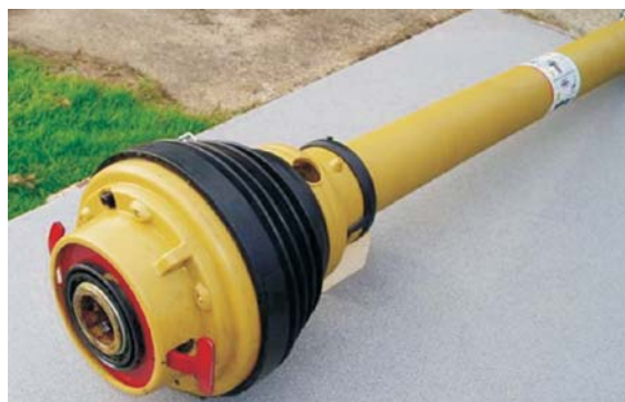
Rys. 5. Nowe bezpieczne rozwiązanie blokowania wału na WOM/WPM [1]
