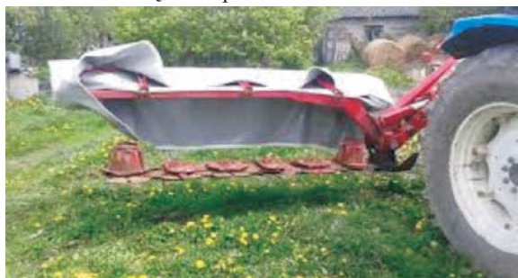
Rys. 6. Kosiarka rotacyjna używana z uszkodzonym fartuchem ochronnym
