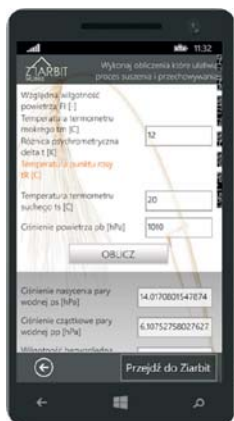
Rys. 4. Przykładowe obliczenia parametrów czynnika suszącego Fig. 4. Exemplary computation of the drying air parameters
