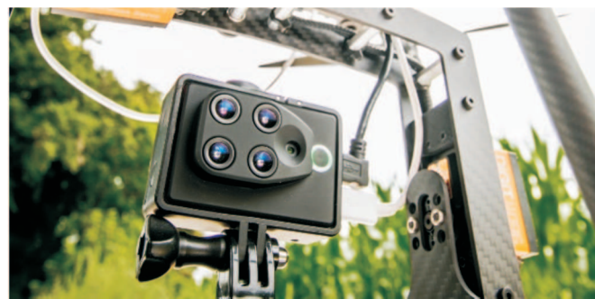
Rys. 3. Wieloobiektywowa kamera Parrot Sequoia zamontowana na multikopterze Agro-Dron® Fig. 3. Multi-lens Parrot Sequoia camera mounted on Agro-Dron® multicopter
