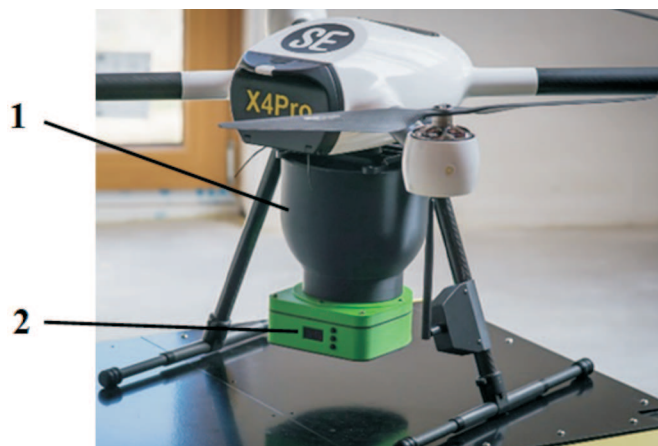
Rys. 5. Quadrokoopter z aplikatorem kapsułek: 1 - zbiornik, 2 - konsola sterująca wyrzutnikiem kapsułek
